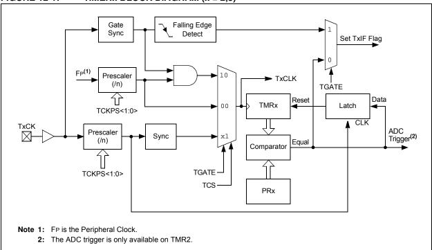
FIGURE 12-2: TYPE B/TYPE C TIMER PAIR BLOCK DIAGRAM (32-BIT TIMER)
